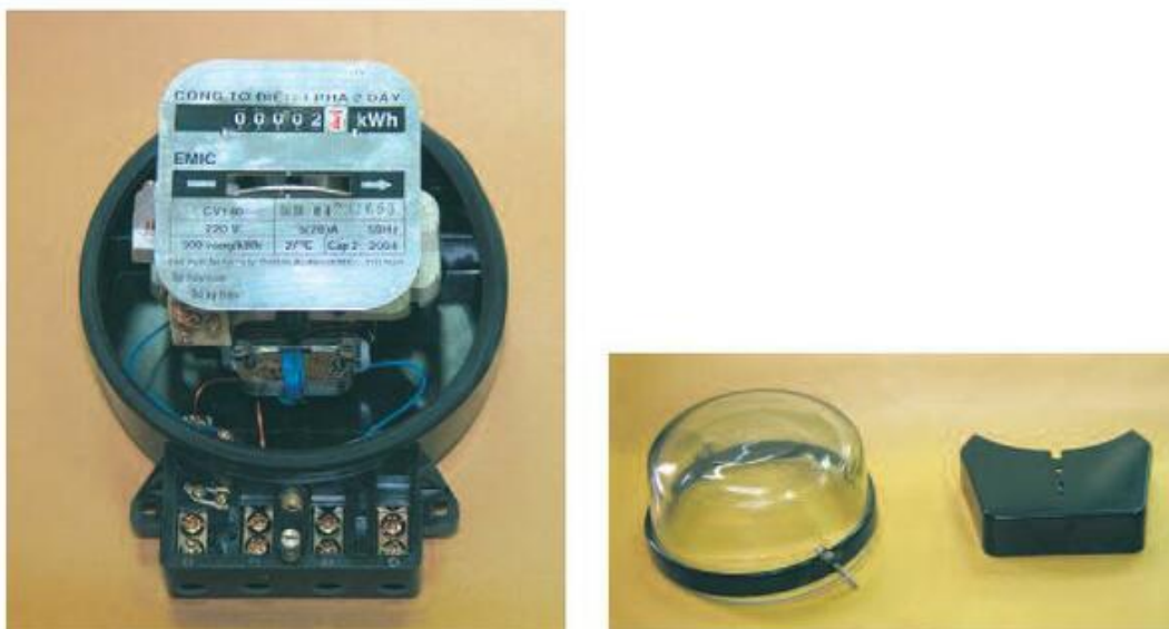
Hình 4 - 1. Công tơ điện.
